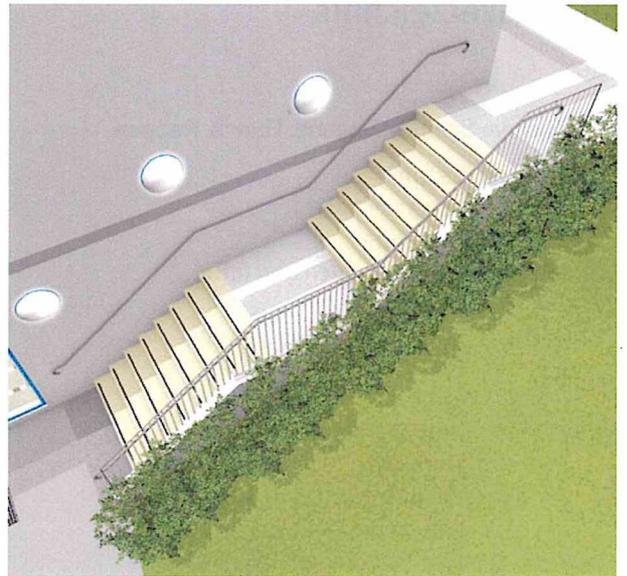
Treppen allein sind keine barrierefreie vertikale Verbindung. Höhendifferenzen können nur durch **Rampen** oder **Aufzüge** barrierefrei überwunden werden. Durch die Einhaltung der unter dem Symbol der Barrierefreiheit aufgeführten Anforderungen können jedoch Treppen von Menschen mit motorischen Einschränkungen sowie von blinden und sehbehinderten Menschen besser benutzt werden.
