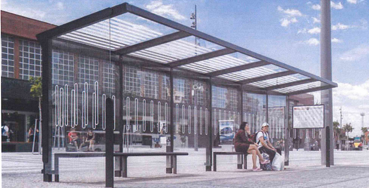
Wartehalle AUREO mit Pultdach, auftragsbezogene Anpassung, Dachbreite x Dachtiefe 8350 mm x 1855 mm, Seiten- und Rückwände ESG Klarglas mit Scheibendekor, inkl. Schaukasten und Sitzbänke, Stahlkonstruktion in RAL 7016 anthrazitgrau
