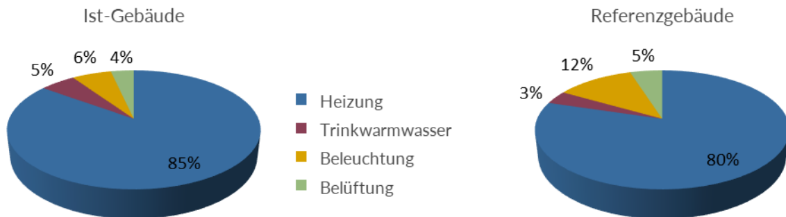
Abbildung 2-6: Verteilung des Endenergiebedarfs im Ist- und Referenzgebäude
