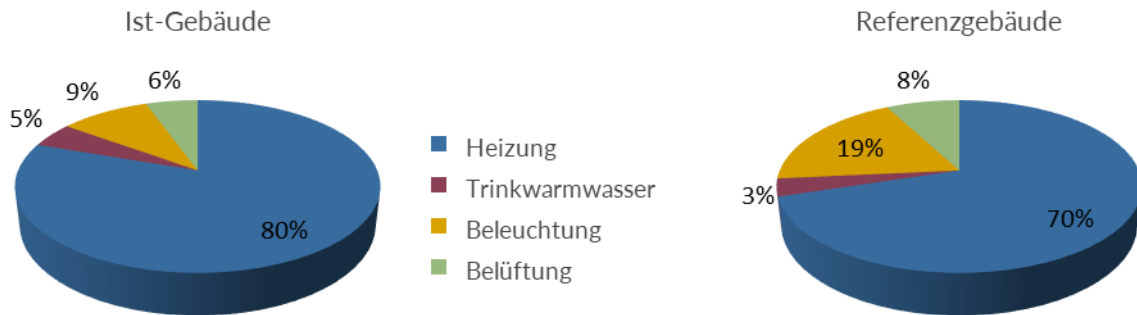
Abbildung 2-7: Verteilung des Primärenergiebedarfs im Ist- und Referenzgebäude
