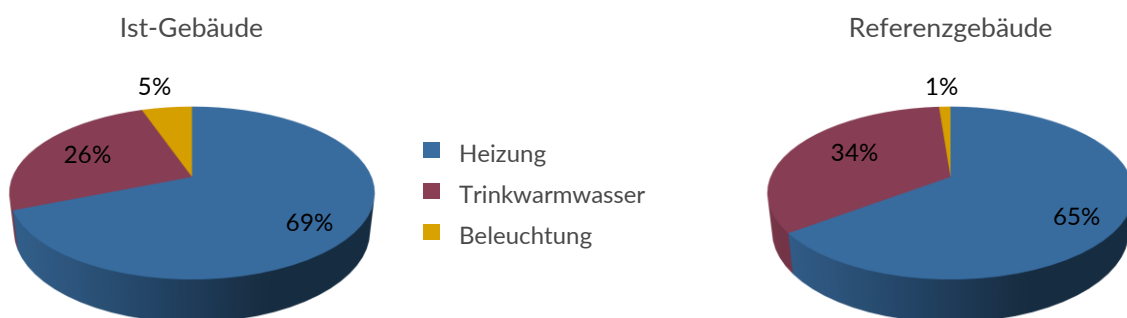
Abbildung 2-5: Verteilung des Nutzenergiebedarfs im Ist- und Referenzgebäude
