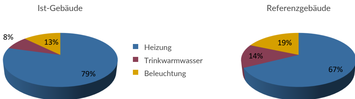
Abbildung 2-7: Verteilung des Primärenergiebedarfs im Ist- und Referenzgebäude
