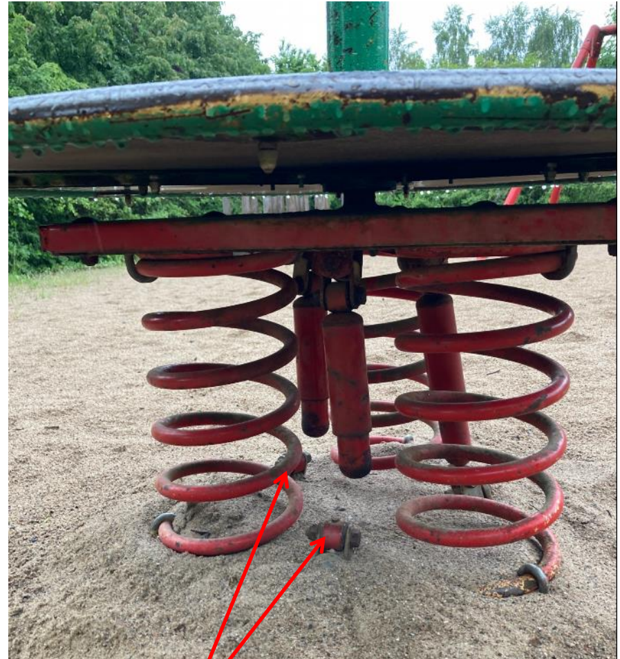
Technischer Defekt am Spielgerät Federbeine verrostet und abgerissen
