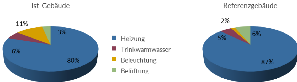
Abbildung 2-7: Verteilung des Primärenergiebedarfs im Ist- und Referenzgebäude
