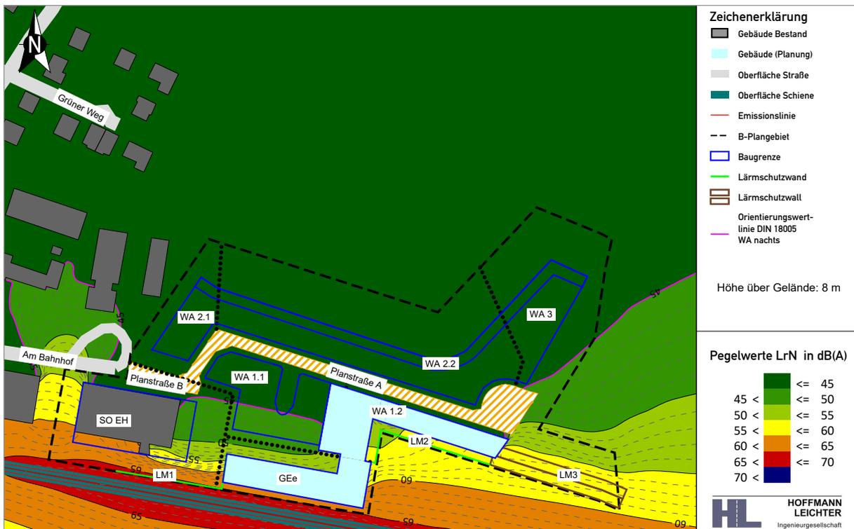
Abbildung 4-9 Isophonenkarte in 8 m Höhe über Gelände | Beurteilung nach DIN 18005 | 22:00 - 06:00 Uhr mit Lärmschutzmaßnahmen
