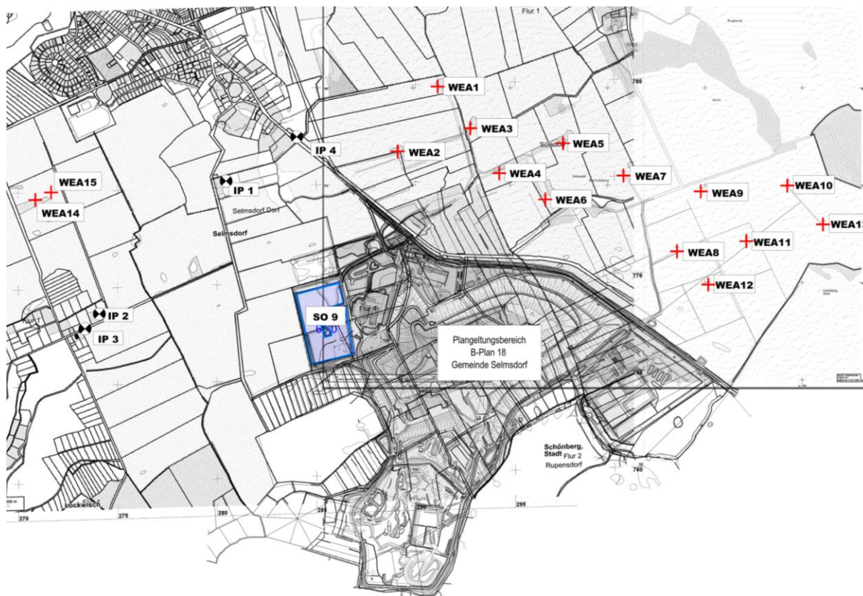
Abb. 5: Lageplan mit Darstellung der Immissionspunkte (IP 1 bis IP 4), Auszug aus der Schalltechnischen Untersuchung, ALN Akustik Labor Nord, Stand 02.03.2023
