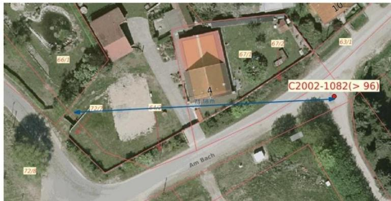
Die vorhandene Hydrant C2002-1082 befindet sich innerhalb des Löschwerradius von 300m und deckt den Grundschutz für 2 Stunden ab.
