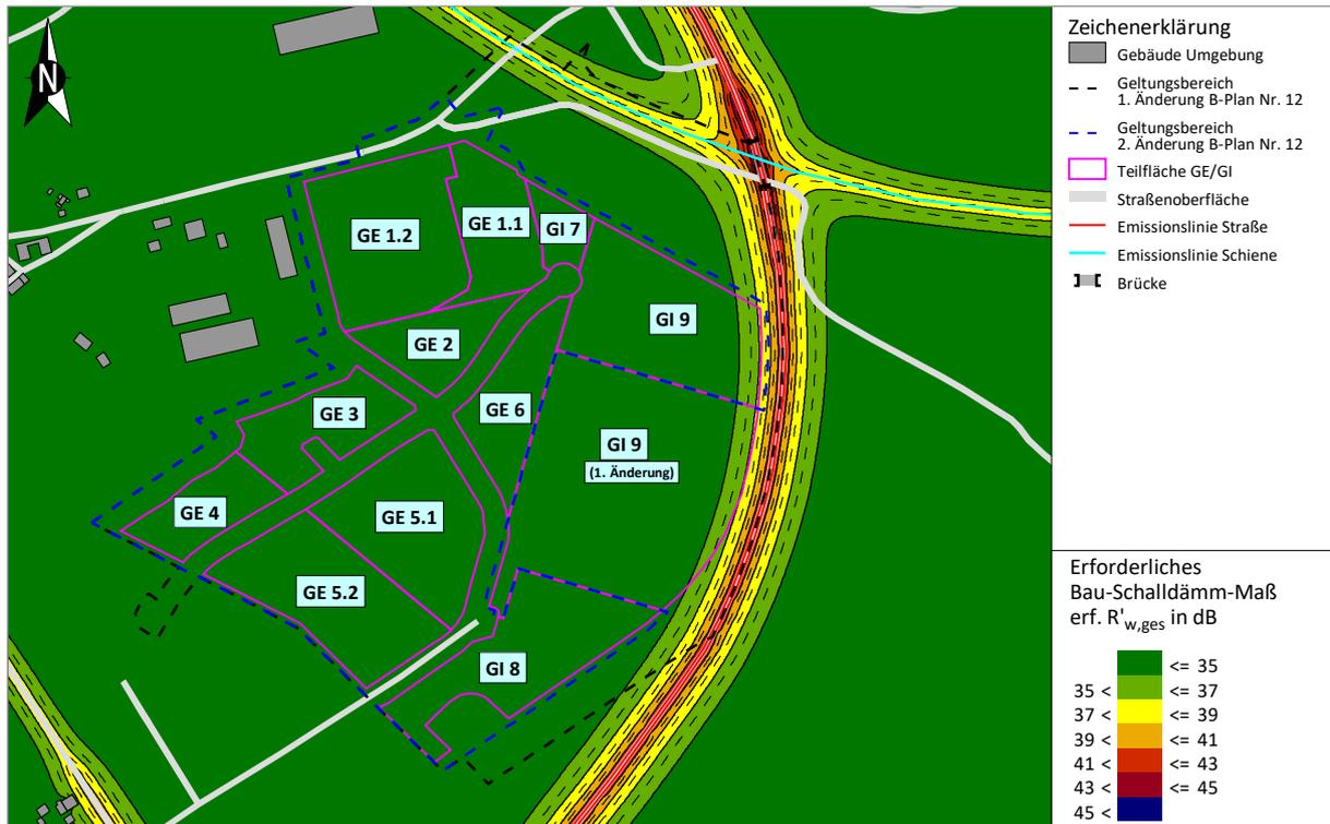
**Abbildung 17** Isophonenkarte in 8 m Höhe über Gelände | Erforderliches gesamtes bewertetes Bau-Schalldämm-Maß gemäß DIN 4109 | Büroräume u. Ä.
