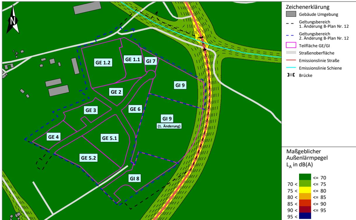
**Abbildung 15** Isophonenkarte in 8 m Höhe über Gelände | Maßgeblicher Außenlärmpegel gemäß DIN 4109 | Büroräume u. Ä.
