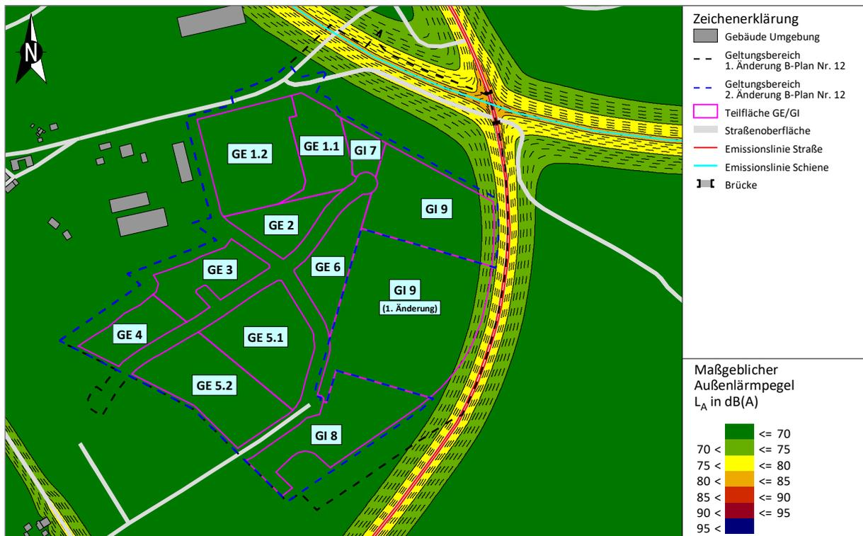
**Abbildung 16** Isophonenkarte in 8 m Höhe über Gelände | Maßgeblicher Außenlärmpegel gemäß DIN 4109 | Aufenthaltsräume in Wohnungen u. Ä.
