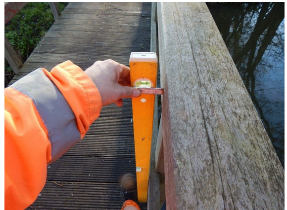
ASL_002_0_2015H_L-GEL NACH AUßEN GENEIGT
