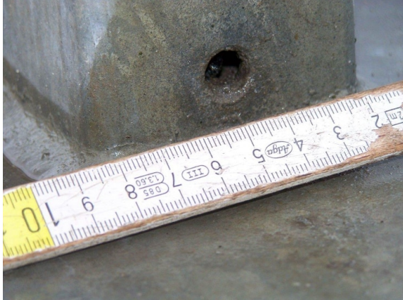
2131501_0_2009H_L-GEL ENTW-ÖFFNUNG ZU HOCH
