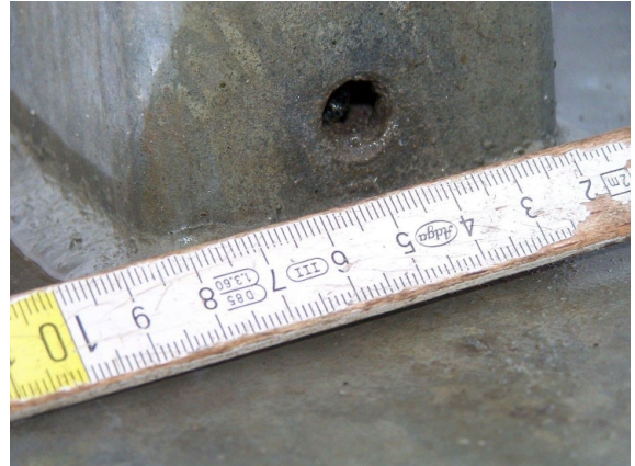
2131501_0_2009H_L-GEL ENTW-ÖFFNUNG ZU KLEIN
