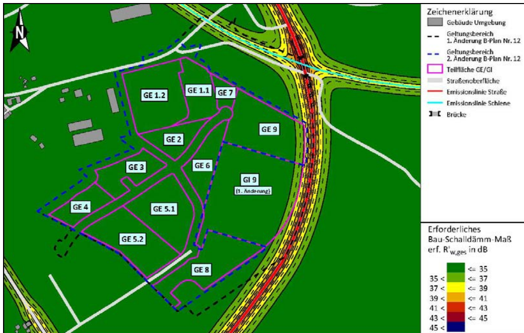
Abb. 6: Isophonenkarte in 8 m Höhe über Gelände/erforderliches gesamtes bewertetes Bau-Schalldämm-Maß gemäß DIN 4109/ Büroräume u.Ä.
