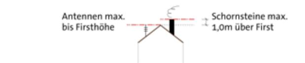
Abb. 32 | Abmessungen von Schornsteinen und Antennen
