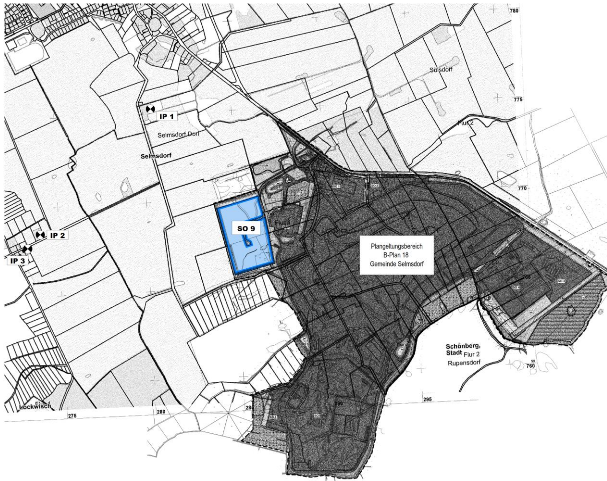
Abbildung 10: Lageplan mit Darstellung der Immissionspunkte (IP 1 bis IP 3), Auszug aus der Schalltechnischen Untersuchung, ALN Akustik Labor Nord
