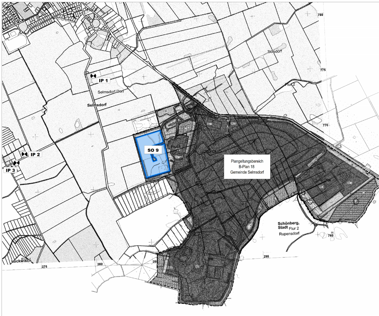
Lageplan mit Darstellung der Immissionspunkte (IP 1 bis IP 3) i.V.m. mit Punkt 6.2 im Teil B - Text, Auszug aus der Schalltechnischen Untersuchung, ALN Akustik Labor Nord
