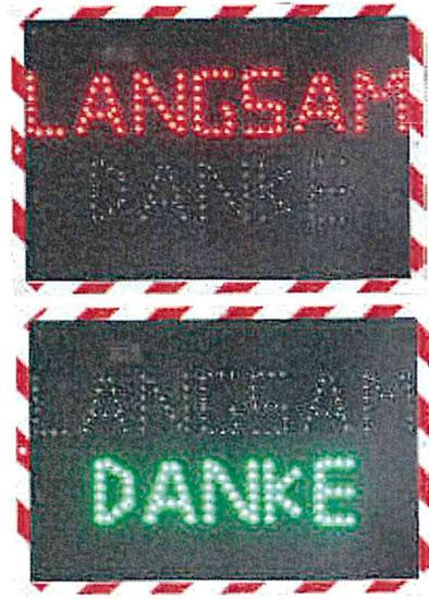
Dialog-Display mit grünem und rotem Text. Bei zu hoher Geschwindigkeit wird gewarnt, bei korrekter Geschwindigkeit gelobt.
