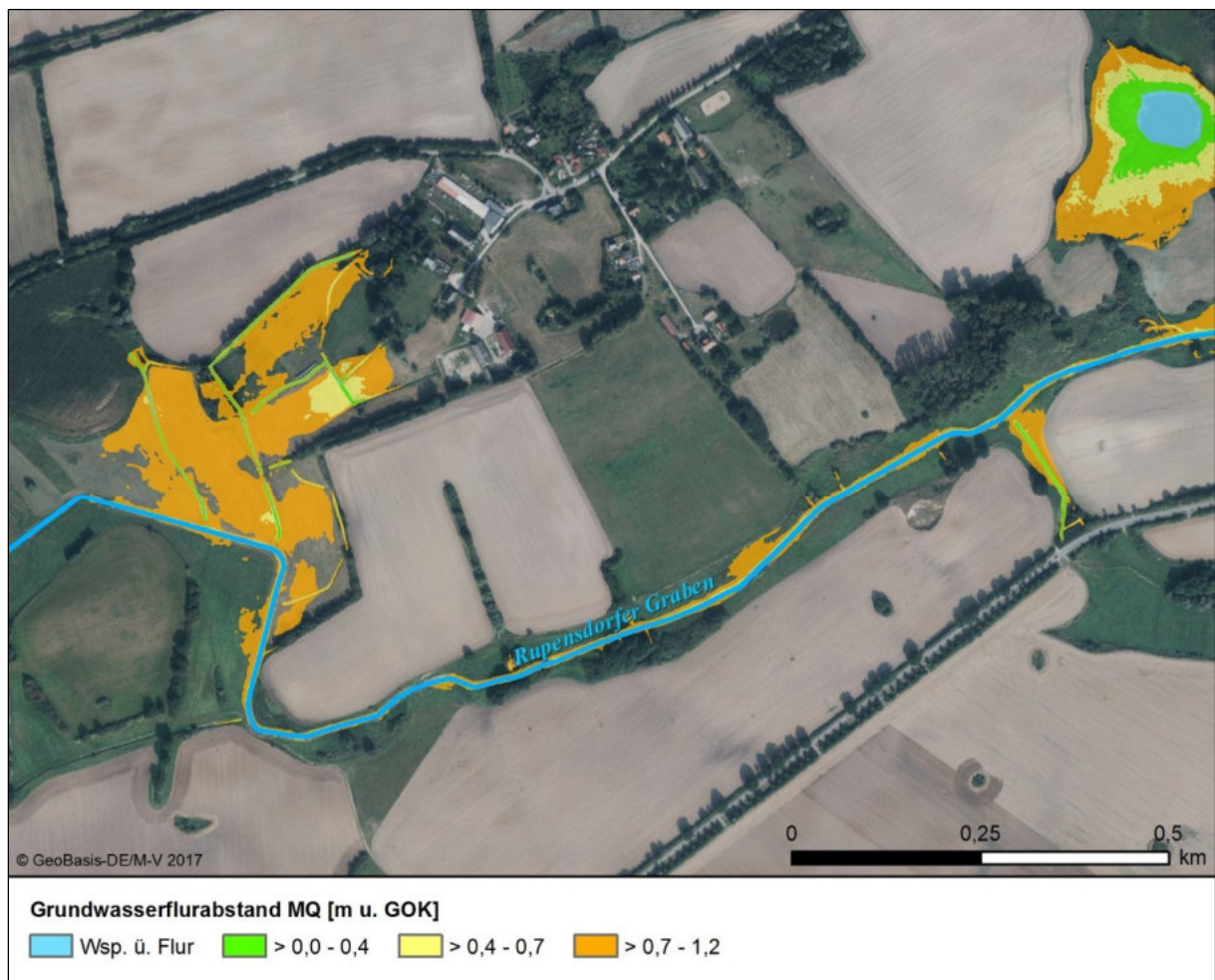
Abbildung 4-6: Grundwasserflurabstände an der Rupensdorfer Graben auf Grundlage der berechneten Wasserspiegellagen MQ (umfangreiche Darstellung vgl. Anhang V)
