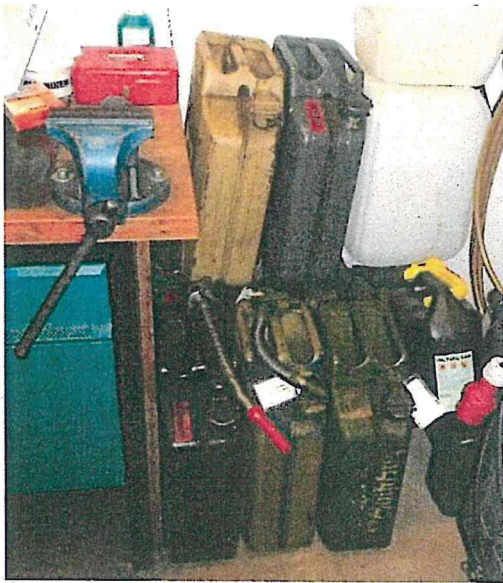
Unzureichende Lagerung brennbarer Flüssigkeiten
