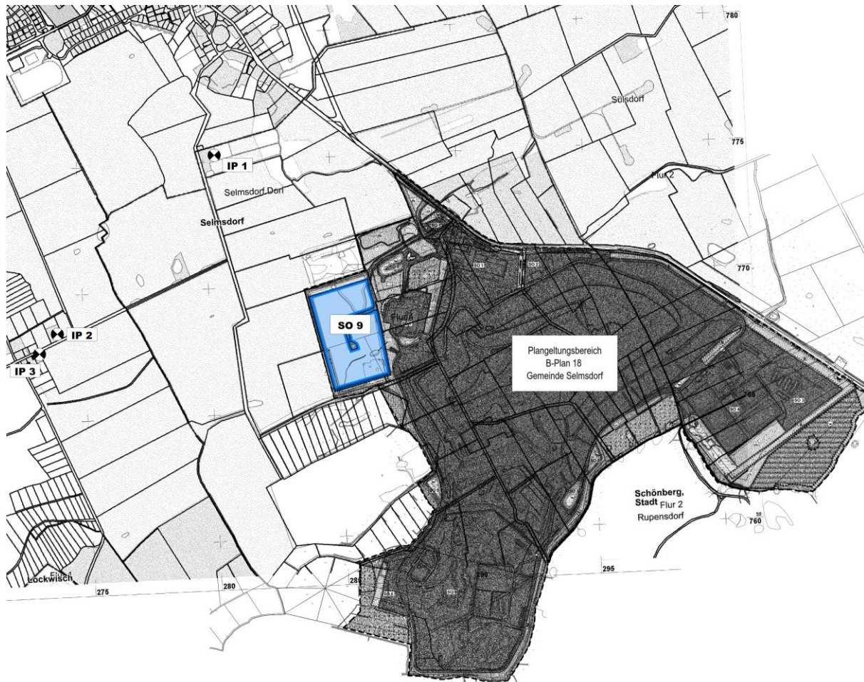
Abbildung 7: Lageplan mit Darstellung der Immissionspunkte (IP 1 bis IP 3), Auszug aus der Schalltechnischen Untersuchung, ALN Akustik Labor Nord
