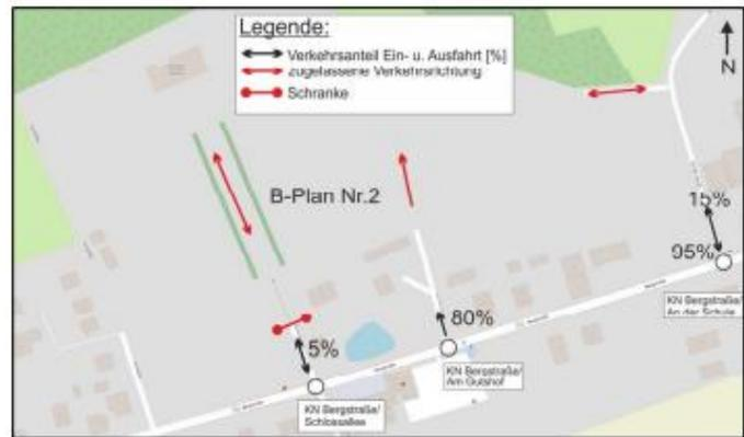
Abbildung 17: Anteilige Verkehrsverteilung des zusätzlich erzeugten Verkehrs durch das B-Plan-Gebiet, aus: Gutachten Inros Lackner
